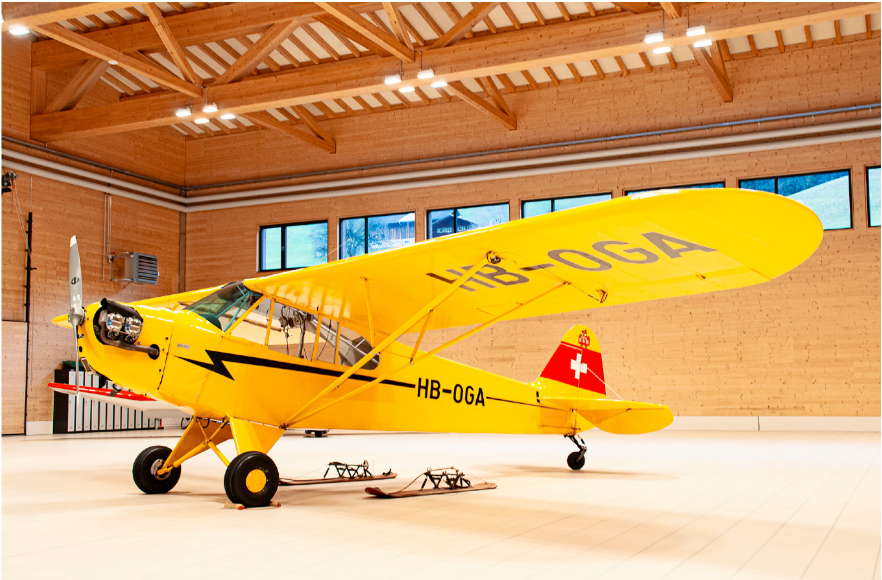
Die einst in militärischen Tarnfarben bemalte Piper J-3C-65/L-4 CUB hatte am 6. Dezember 1944 ihren Erstflug. Hinter den Rädern die Skis für Gletscherlandungen. FOTOS: KEREM MAURER
