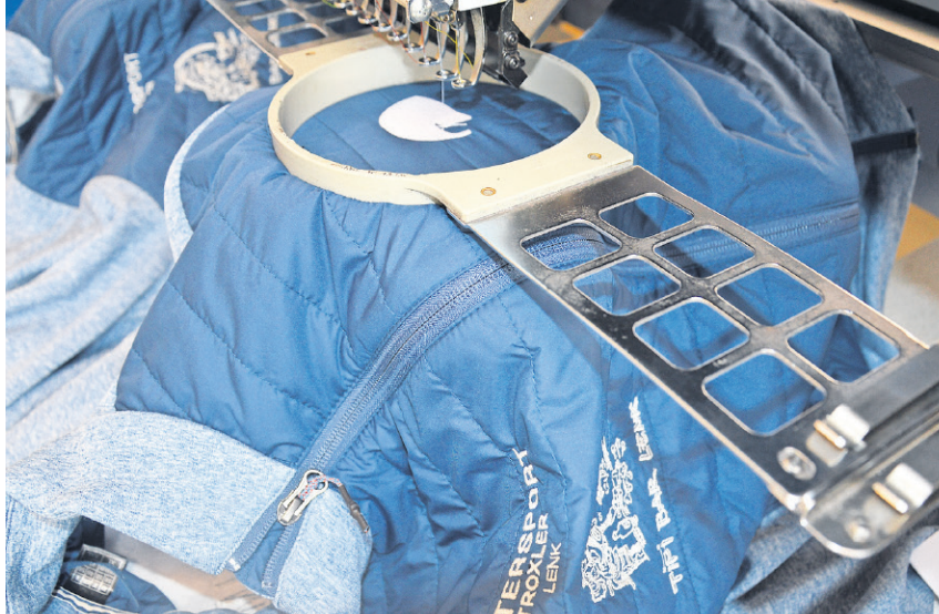
Per Computer programmiert, läuft das Besticken der Jacke automatisch.
