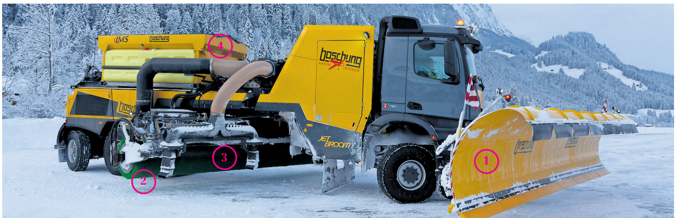
Der grosse Star: Jetbroom 10000. 1. Die Schaufel ist 8,4 Meter breit. 2. Die Bürste räumt den Schnee schwarz. 3. Das Gebläse beseitigt den Schnee vor und nach der Bürste. 4. Der Tank beinhaltet das Salz.
