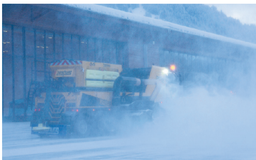
Bei der Schwarzräumung fegt der Blaskanal den Schnee weg.
